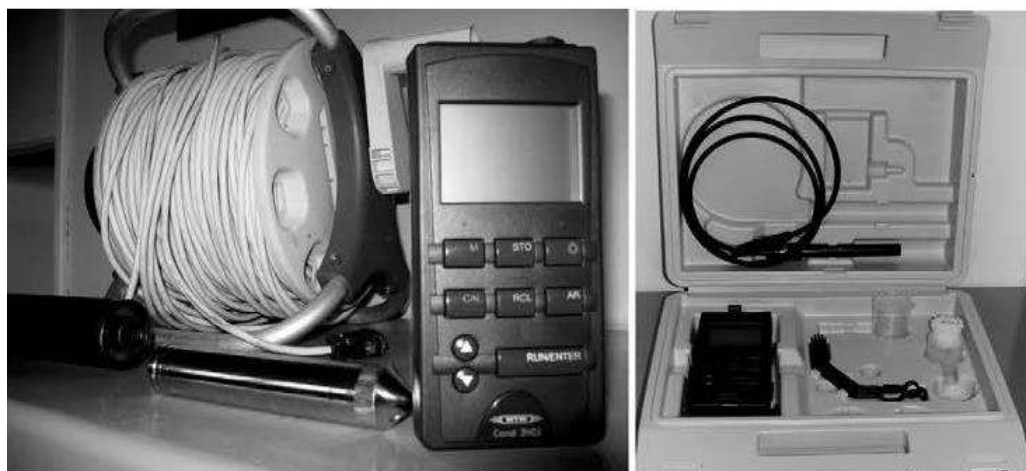
الشكل ٢٦-٩ المعدات المتنقلة لمراقبة جودة المياه الجوفية.
