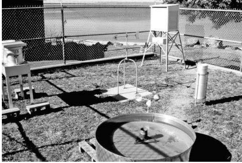
الشكل ٥-٢١ محطة أرصاد جوية مائية مزودة بأجهزة لقياسات التبخر المباشر (مقياس التبخر المباشر) (مقياس التبخر في المقدمة)، وسرعة الرياح، وهطول الأمطار، ودرجة حرارة الهواء، والتشمس (ساعات سطوع الشمس).
