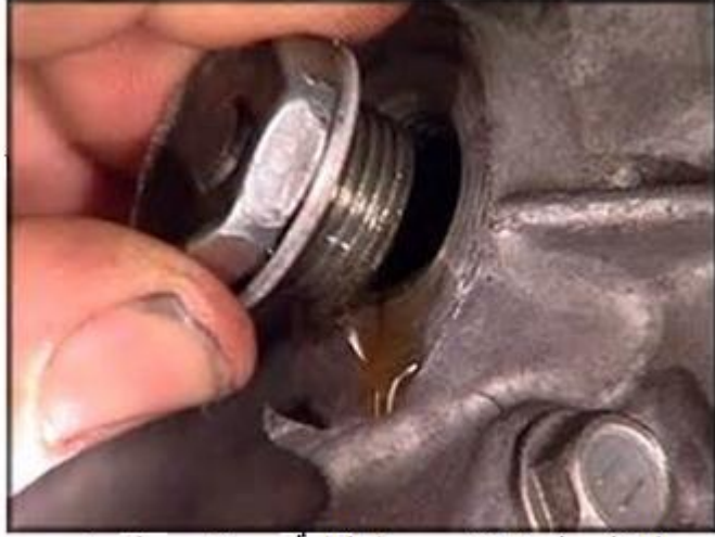
الشكل رقم ( ٢١ ) : ربط الطبة بعد تزويد الزيت
