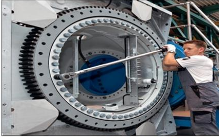
الشكل رقم ( ٤٢ ) : طريقة استعمال مفتاح العزم اليدوي
