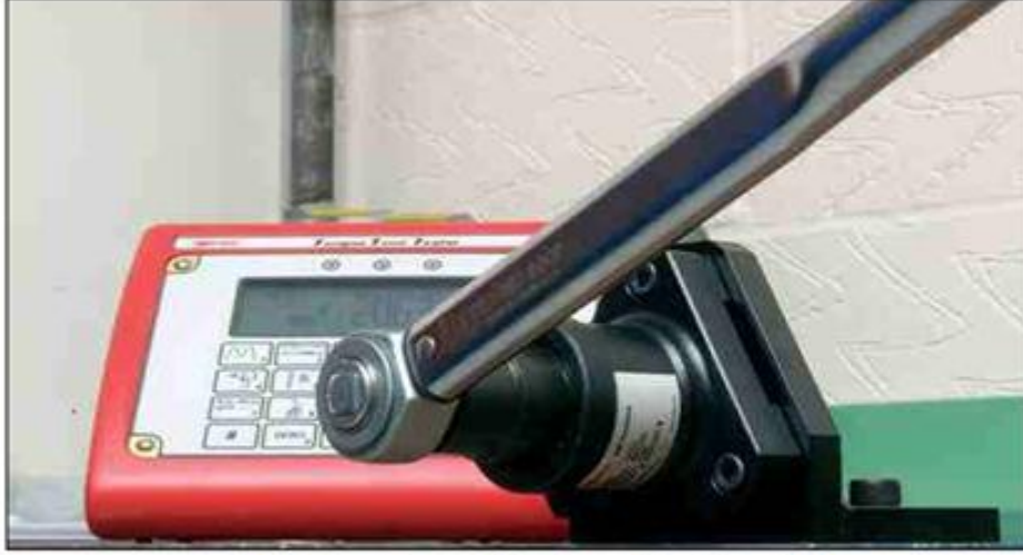
الشكل رقم (٤) : طريقة استعمال مفتاح العزم
