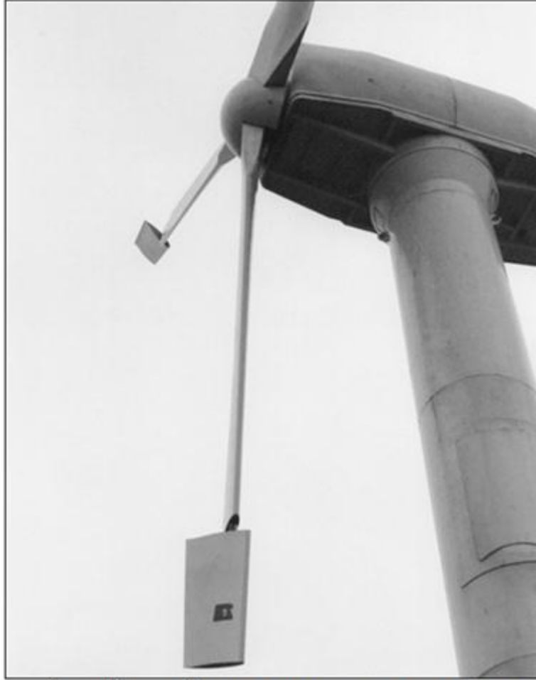
الشكل رقم (٤٢- ب): الفرامل الهوائية في نهاية الريشة
