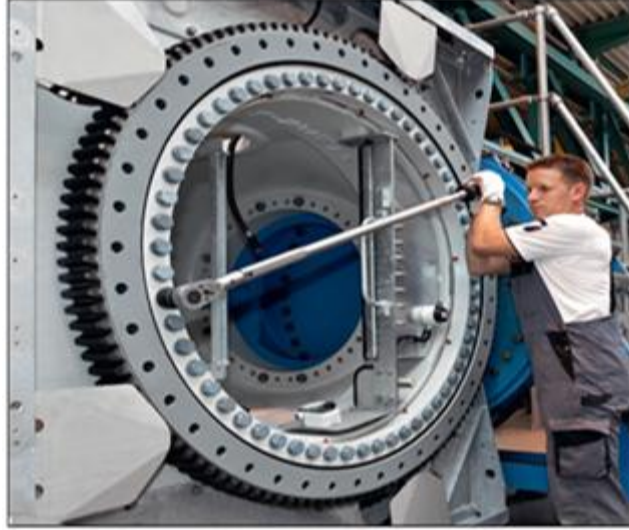
الشكل رقم (٣٢) : طريقة استعمال مفتاح العزم اليدوي
