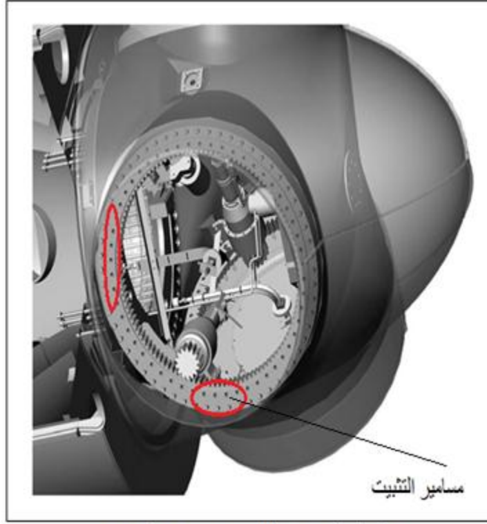
الشكل رقم (٣٨) : قطاع تشریحی فی الصرة
