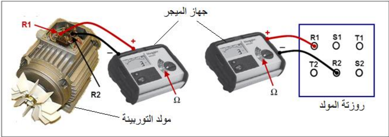
الشكل رقم (١٤): قياس استمرارية التوصيل في مولد التوربينة باستخدام الميكر
