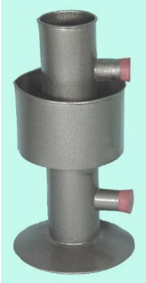
يستخدم جهاز هوب لدراسة شذوذ الماء
