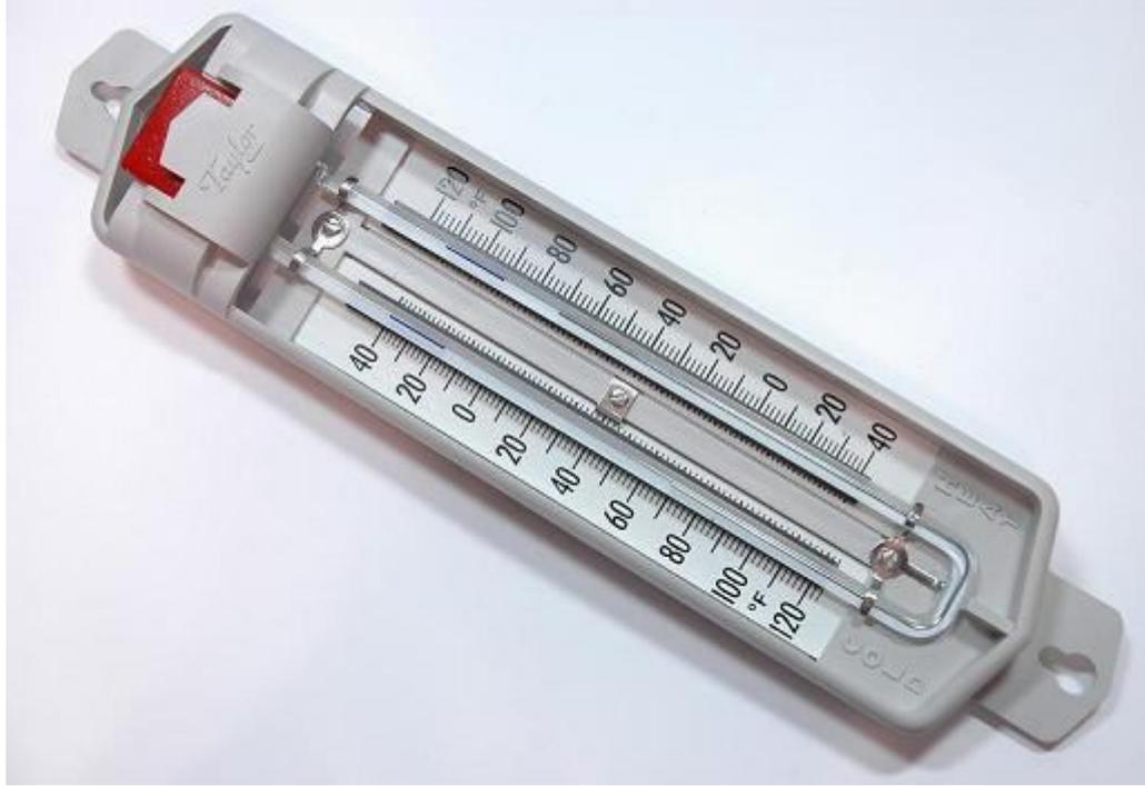
وإذا برد الجو سوف يتقلص الكحول ويعود للمستودع الأيسر ساحباً معه الزئبق للشعبة اليسرى ، وعندما يرتفع الزئبق في الشعبة اليسرى يدفع معه قطعة الحديد، أما قطعة الحديد اليمنى فتبقى مكانها لأن الزئبق يتركها وراءه ولا يستطيع الكحول أن يحركها، ولهذا تؤخذ الدرجة الصغرى عند أسفل قطعة الحديد في الشعبة اليسرى
