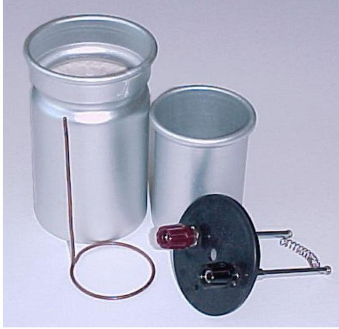
الهدف : صنع مسعر جول لدراسة العوامل التي يعتمد عليها الأثر الحراري للتيار الكهربائي .
