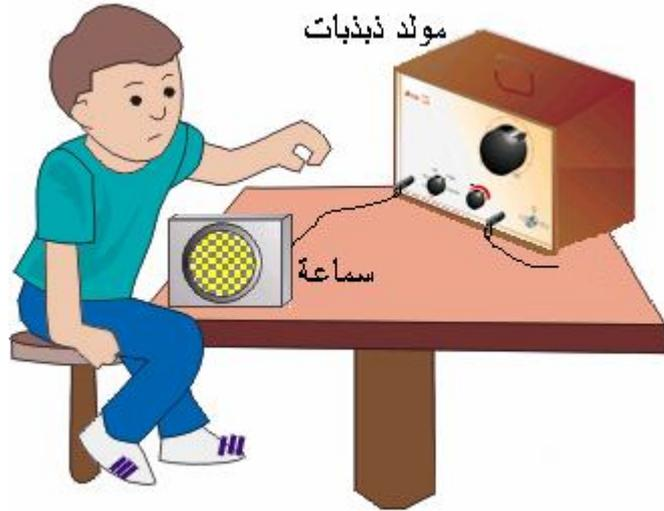
ولقياس مدى السمع يتم اختيار مكان هادئ ووصل مخرج الجهاز مع سماعة عادية ورفع التردد تدريجيا ابتداء من ١ ثم يزيد حتى يبدأ بالسمع ، فيكون هذا هو الحد الأدنى وكما قلنا يكون بحدود ٢٠ هيرتز و ثم يستمر بزيادة التردد تدريجيا حتى لا يسمع شيئا ، وفي هذه اللحظة يثبت مفتاح الجهاز ويكون هذا هو الحد الأعلى للسمع لهذا الشخص .
