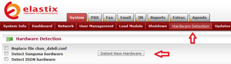
وفيها نضع إشارة أمام Detect ISDN hardware إذا كانت البطاقة رقمية و نضع إشارة أمام Detect Sangoma hardware إذا كانت البطاقة من إنتاج شركة Sangoma وأخيرا نضغط على Detect New Hardware ليقوم النظام بالتعرف على البطاقة كما في الصورة التالية:
