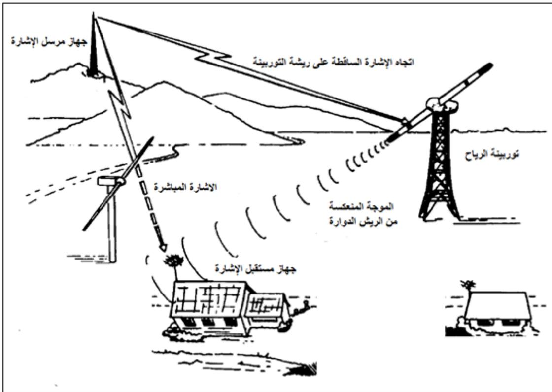
الشكل رقم (٣٨) : تداخل الموجات المرسلة بسبب التوربينات
