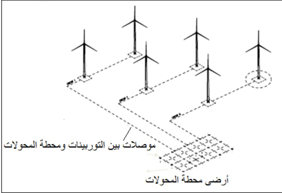
الشكل رقم (٢٩) : ربط أرضى التوربينات بأرضى المحولات
