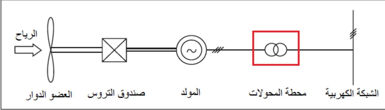
الشكل رقم (٦) : منظومة ربط التوربينة بالشبكة الكهربائية
