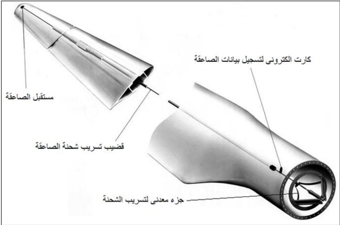
الشكل رقم (٣٢) : مكونات أجزاء الحماية بالريشة
