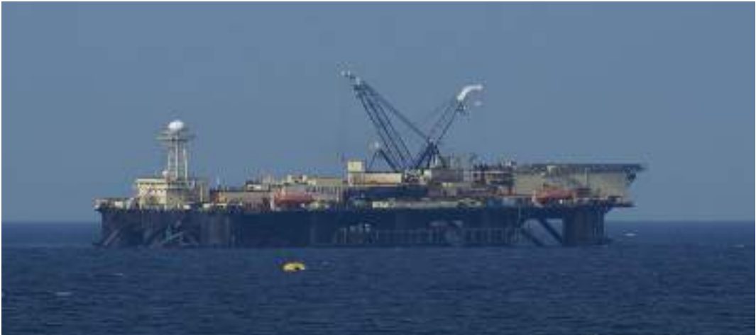
سفينة مد الأنابيب شبه الغاطسة كاستور سي التابعة لشركة نورد ستيرم في بحر البلطيق جنوب شرق جوتلاند، السويد في أواخر مارس 2011.
