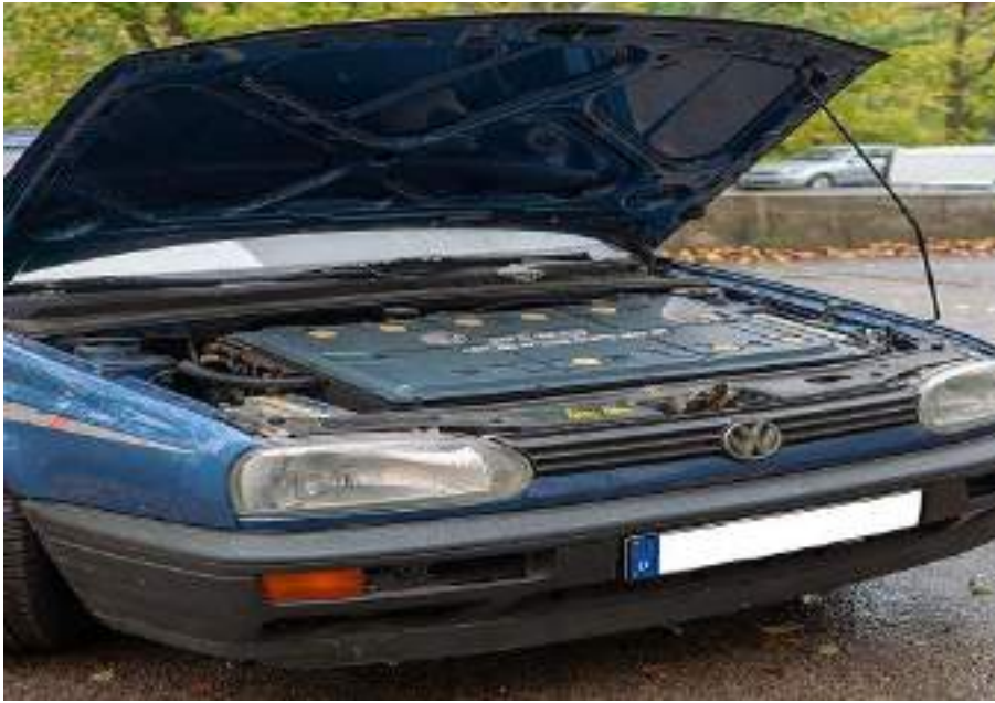
حزمة بطارية تحت غطاء محرك الجولف سبيس سترومر الكهربائي.
