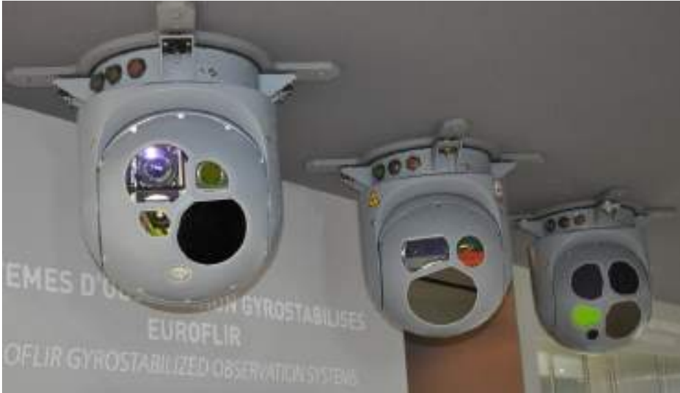
الكرة الألكترونية المستقرة (جيروسكوب القاع) Sagem Euroflir 410
