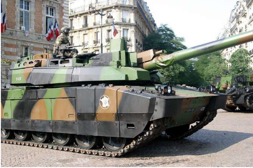
وحدات الدرع سهله التغير، وعلى أطراف الهيكل درع جانبي.
