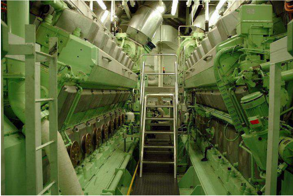
اثنان من مولدات التيار المتردد طراز Wärtsilä 16V32
