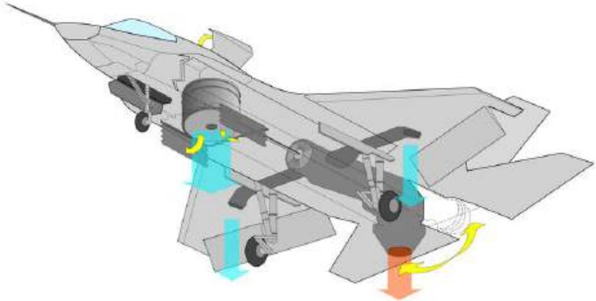
الرسم التخطيطي لمكونات نظام الرفع وتدفع الهواء (LiftSystem)
