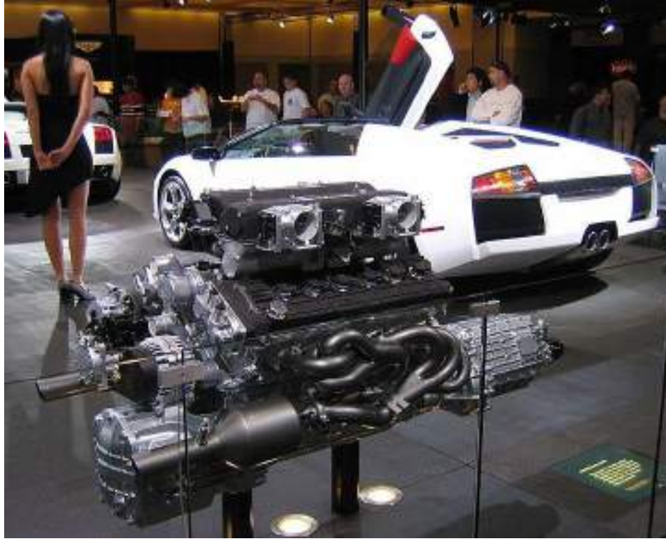
المحرك ذو سعة 6.2 لتر الموجود بسيارة مورشيلاجو من الجيل الأول
