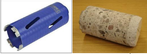
أداة الحفر الحديثة من معدن (WiDea) والنواة المنزوعة من الحفرة بعد عملية الثقب.
