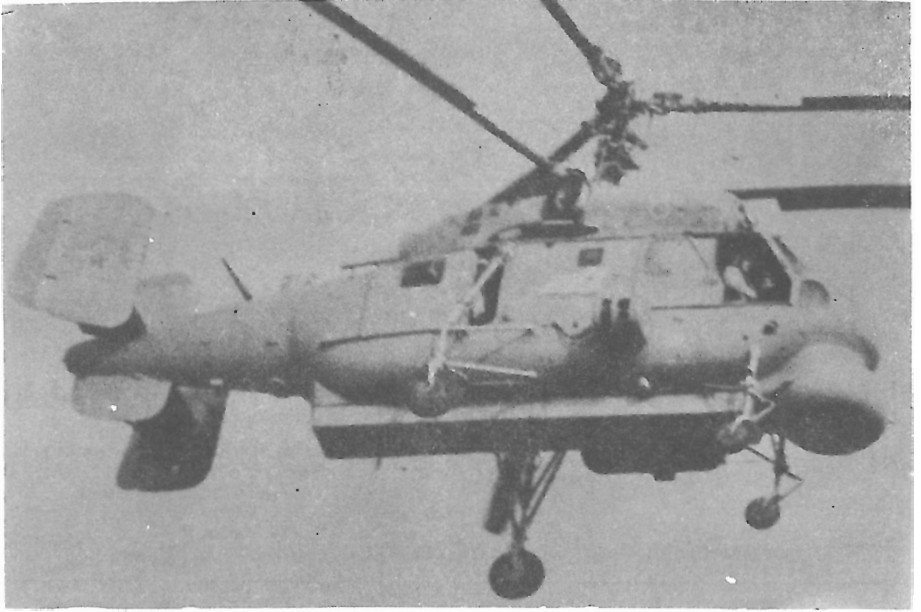
صورة رقم 35 : طائرة هيليكوبتر مضادة للغواصات Kamov Ka Hormone (سوفيتية) وهي تحمل رادار الذفن
