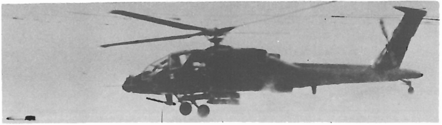
صورة رقم 29 : صاروخ جو أرض ضد المدرعات Hellfire (أمريكي) تطلقه طائرة هليكوبتر AH-64 Apache
