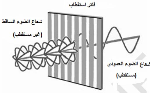
على اتجاه الحركة، ولكن هذه الحرية مقيدة في حالة الضوء المستقطب، وأبسط نوع منه هو الضوء المستقطب في المستوى حيث يهتز المجال الكهربائي في اتجاه واحد ثابت بحيث تبدو الموجة وكأنها خيط متذبذب.
