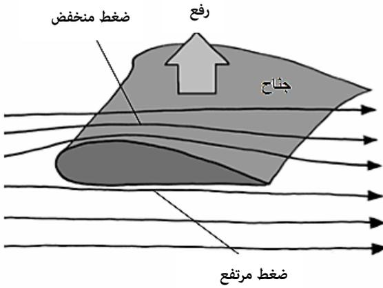
يقول المبدأ أن الضغط في تيار الهواء السريع أقل من الضغط في تيار الهواء الأبطأ منه، ويتم تصميم جناح الطائرة على شكل منحني حتى يكون الهواء الذي يمر فوقه أسرع من الهواء الذي يمر من تحته، وهذا ينشئ فرقاً في الضغط بين الأعلى والأسفل، وكما أن
