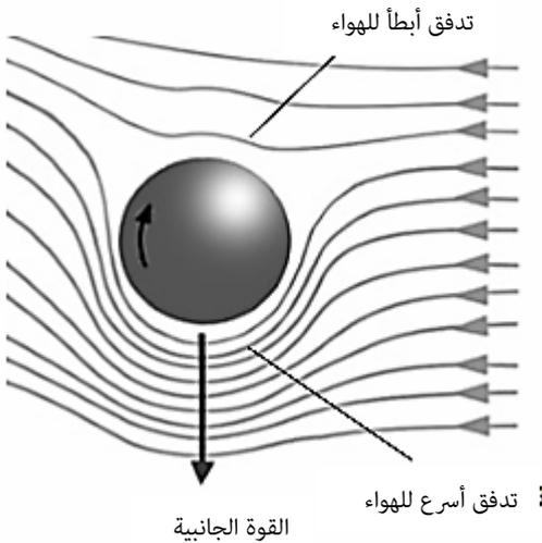
وعندما يكون السطح كرةً دوارةً فإن الطبقة الحدودية تنشئ دوامةً دائريةً حول الكرة وهي تتحرك في الهواء، وفي أحد جوانب الكرة يتحرك الهواء الذي في الدوامة في نفس اتجاه حركة الهواء الذي يمر بعيداً عنها، مما يجعل هواء الدوامة يسرع ذلك الهواء قليلاً، وعلى النقيض من ذلك في الجانب الآخر من الكرة حيث تعمل الدوامة على إبطاء حركة الهواء
