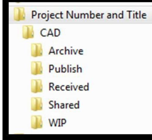
عند البدء في عمل التصميم نعمل على WORK IN PROGRESS حيث يعمل كل أعضاء الفريق على المشروع في هذا المجلد و توجد هنا كل المخططات و الرسومات الجاري العمل عليها , هذا هو مكان الملفات التي لم يتم الموافقة عليها بعد .
