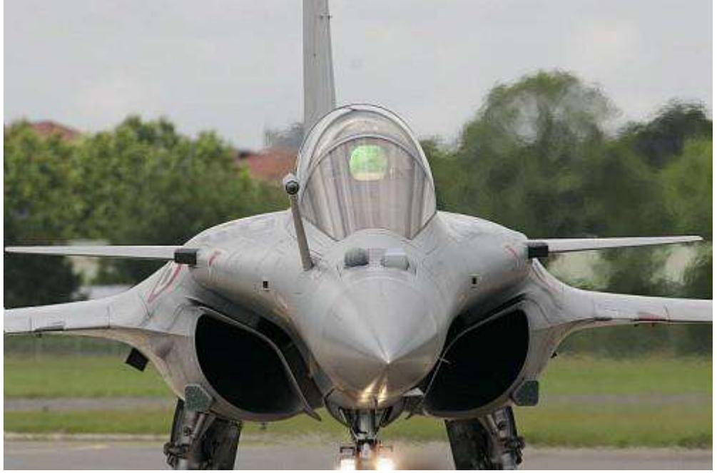
النظام الكهرو- بصري (OSF) يُرى في مقدمة الطائرة أسفل قمرة القيادة وبجانب ذراع التزود بالوقود
