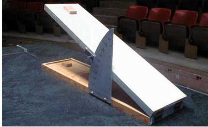
عندما تحاول تحريك جسم فوق سطح فإن هناك قوة تحاول إعاقة الحركة ، وتنشأ هذه القوة بسبب التلامس بين الأسطح . ويسببها وجود نتوءات على الأسطح مهما بدت ملساء ، وعندما يحاول الجسم الحركة أو يتحرك فعلاً تتداخل النتوءات مع بعضها البعض وتمنع حركة الجسم . وتسمى هذه القوة " قوة الاحتكاك " وتكون هذه القوة دائماً في اتجاه معاكس للحركة وموازية للسطح
