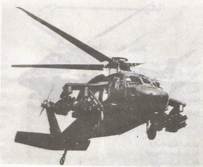
طائرة هيليكوبتر أمريكية طراز UH-60A . واسمها الشائع هو الصفير الأسود Black Hawk وتحمل 16 صاروخ مضاد للدبابات من طراز Hellfire (AGM-114) . ومدى الصاروخ 8 كيلومتر
