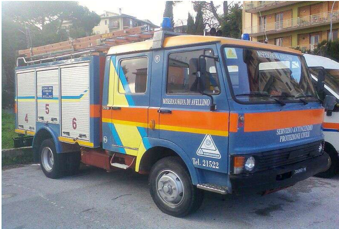
(إيطاليا) Iveco-Fiat 79.13 شاحنة إطفاء ذات مقصورة مزدوجة من طراز
