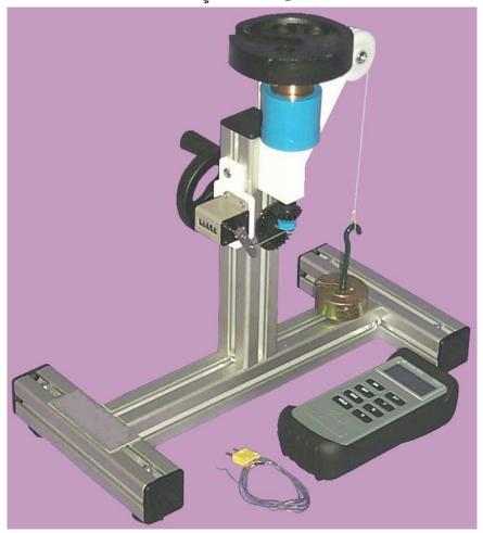
الهدف: صنع جهاز لقياس المكافئ الميكانيكي للحرارة .
