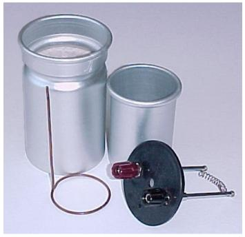
الهدف : صنع مسعر جول لدراسة العوامل التي يعتمد عليها الأثر الحراري للتيار الكهربائي . المواد :
