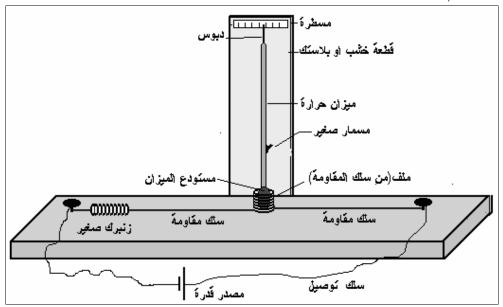
٥. على ارتفاع (٢) سم من مستوى السلك اثقب ثقبا صغيرا خلف ميزان الحرارة ثم الصق الرأس العريض للمسمار بميزان الحرارة وادخل المسمار في الثقب ، سوف يستخدم كمحور لحركة ميزان الحرارة بحيث يكون المسمار عموديا على ميزان الحرارة وبهذه الطريقة سوف يستعمل ميزان الحرارة بغرضين أولهما قياس درجة حرارة السلك وثانيهما استعماله كمؤشر يدل على استطالة السلك .
