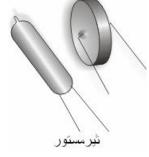
تنقص مقاومة بعض المواد إذا تم تسخينها وهذا ما يحدث في الثيرمستور ،وهو قطعة الكترونية أشباه الموصلات ويصنع عادة من السيلكون، وهو مصمم خصيصا للتأثر بدرجة الحرارة ، ويختلف الثيرمستور عن باقي المقاومات حيث تتخفض مقاومته للتيار الكهربائي بارتفاع درجة حرارته
