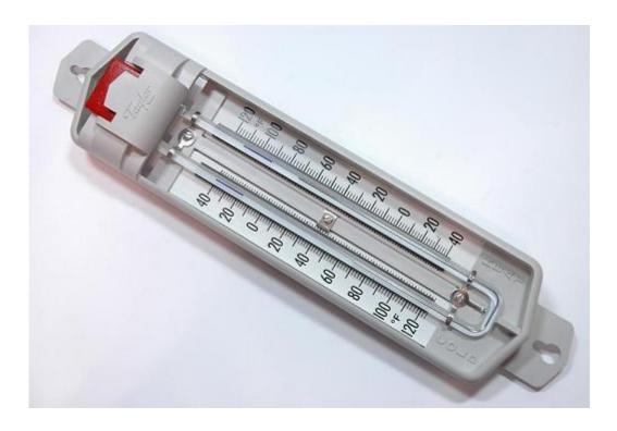
وإذا برد الجو سوف يتقلص الكحول ويعود للمستودع الأيسر ساحبا معه الزئبق للشعبة اليسرى ، وعندما يرتفع الزئبق في الشعبة اليسرى يدفع معه قطعة الحديد،أما قطعة الحديد اليمنى فتبقى مكانها لأن الزئبق يتركها وراءه ولا يستطيع الكحول أن يحركها،ولهذا تؤخذ الدرجة الصغرى عند أسفل قطعة الحديد في الشعبة اليسرى
