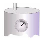
يتكون من شريط معدني ،هذا الشريط مكون من طبقتين من معدنين مختلفين في معامل التمدد بالحرارة (مثلا:نحاس وحديد) ،ويستخدم هذا التصميم في أجهزة منظمات الحرارة (الثيرموستات) وفي قياس درجة الحرارة مثل المستخدم في السخانات الشمسية
