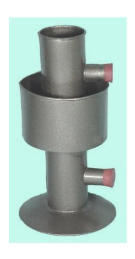
يستخدم جهاز هوب لدراسة شذوذ الماء
