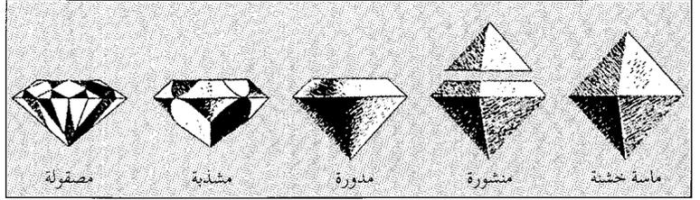
**قطع الماس** يبدأ عندما يقوم صناع مهرة بشطر الماس الخشن الخام إلى نصفين. ويستخدمون في ذلك منشاراً دائرياً مطلياً بغبار الماس. وتسمى الأركان بحك ماسة ثابتة بأخرى دوارة، وبعد ذلك يستخدم الصناع طريقة التشذيب؛ لصفل أوجه الحجر الكريم. ويتطلب التشذيب (إلى اليسار) ضغط الماسة بعناية على عجلة دوارة مطلية بغبار الماس. وتحتوي أغلب الماسات المصقولة على ٥٨ وجهاً.
