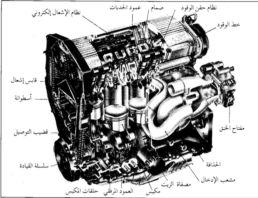
الأجزاء الأساسية محرك البنزين. الأجزاء الأساسية في محركات البنزين الترددية متشابهة جداً. فكلما ارتفع المكبس أو هبط، أدارت قضبان التوصيل العمود المرفقي. والشكل يوضح أجزاء محرك سيارة ذات أربع أسطوانات، فيها نظام إشعال إلكتروني لتسهيل تشغيل السيارة. وفيها كذلك نظام حقن الوقود بدلاً من الكاربريتور لتوفير استهلاك الوقود.
