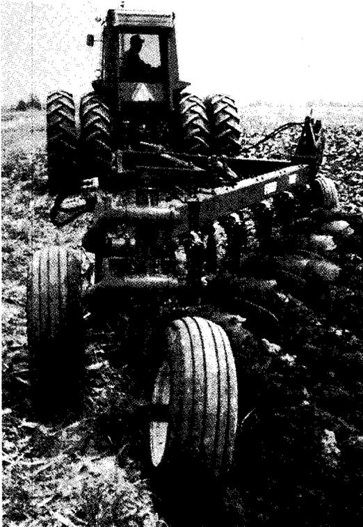
محراث جرار يسحب بوساطة الجرار. والمحراث، الموضح أعلاه، له ٧ أنصال تُسمى الجاريف. ويستخدم هذا المحراث مجاريف من النوع القلاب وهو النوع الأكثر شيوعاً.
