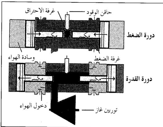
محرك الاحتراق الحر يعمل عن طريق تحريك المكابس خارج وسادات الهواء. فكلما تحركت المكابس إلى الداخل «أعلى الشكل» تضغط الهواء الذي يوجد بينها وينفجر الوقود في غرفة الاحتراق فيسعد المكابس عن بعضها «أسفل الشكل» وتخرج الغازات الساخنة فتحرك التوربين.
