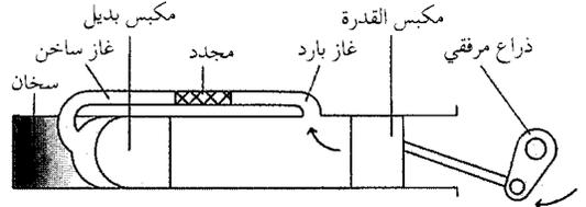
تبدأ دورة محرك ستيرلنج عندما يتحرك مكبس القدرة نحو المكبس البديل. هذه الحركة تجعل الهواء البارد بين المكسبين يرتفع إلى المجدد.
