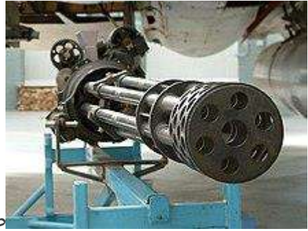
طائرة إف-15 إي تحت الصيانة ويشاهد المدفع الرشاش إم-61 فولكان جاتلينج بعد أن تم إزالة غطاءه
