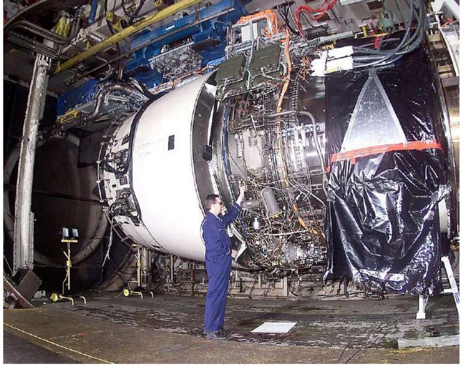
يقوم جيريمي جالاند، في التركيبات في شركة رولز رويس، بفحص الأجهزة الخاصة بمحرك ترينت 900 للاختبار في منشأة اختبار الدفع الهوائي التابعة لمركز أرنولد للتطوير الهندسي. خضع المحرك، الذي تم اختياره كمحرك لطائرة الركاب إيرباص إيه 380، لاختبارات التشغيل والأداء والتجمد.
