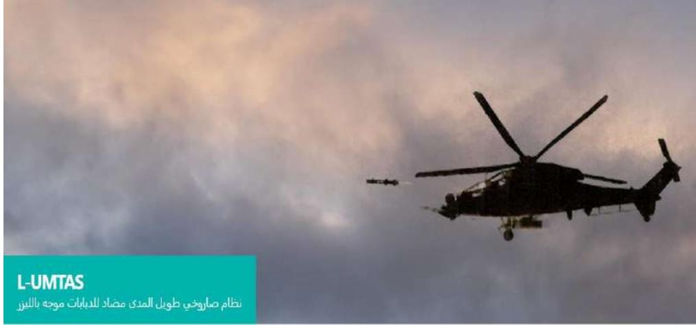
نظام الصواريخ المضادة للدبابات طويل المدى الموجه بالليزر [L-UMTAS] هو نظام صاروخي موجه بدقة مضاد للدبابات تم تطويره بشكل أساسي للتكامل مع منصات طائرات الهليكوبتر.
