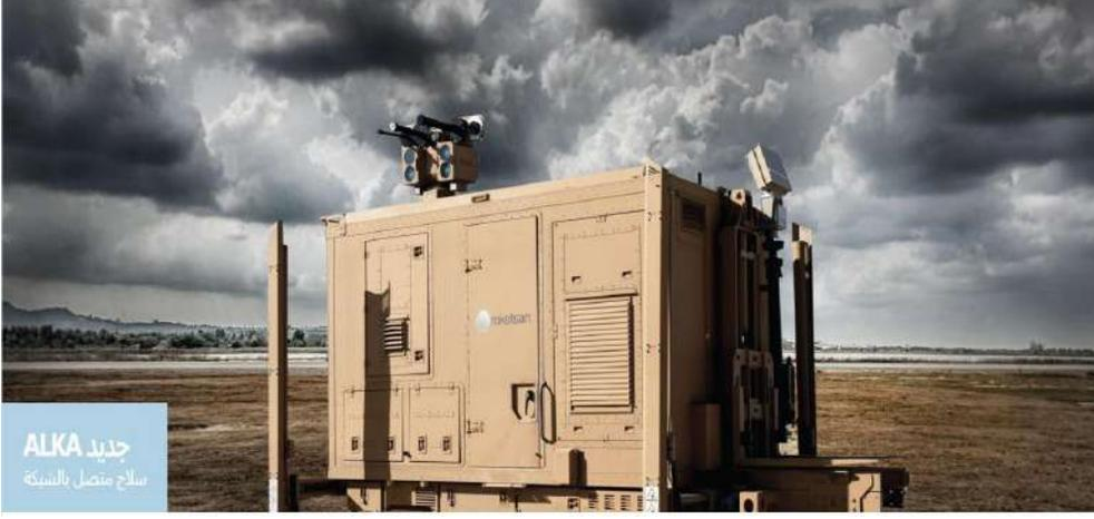
نظام أسلحة الطاقة الموجهة [ALKA [DEWS]؛ يستخدم التكنولوجيا الكهرومغناطيسية والليزر ضد التهديدات غير المتماثلة كنظام دفاع جوي هجين قريب جدًا.
