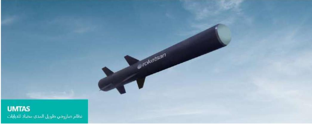
نظام الصواريخ طويلة المدى المضادة للدبابات [UMTAS] هو نظام صاروخي موجه بدقة مضادة للدبابات تم تطويره للتكامل بشكل أساسي مع طائرات الهليكوبتر الهجومية. يسمح جهاز التصوير بالأشعة تحت الحمراء الخاص به بالاستخدام ليلاً ونهاراً، وفي جميع الظروف الجوية السيئة.
