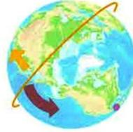
Avec une inclinaison supérieure à 90°, l'orbite se décale vers l'ouest, dans le sens contraire de la rotation de la Terre
