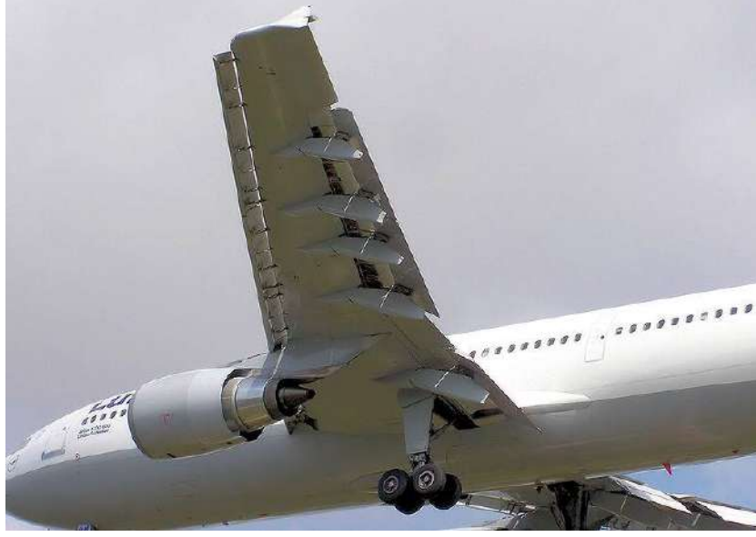
جناحي A300-600 وزعانفها مفرودة
