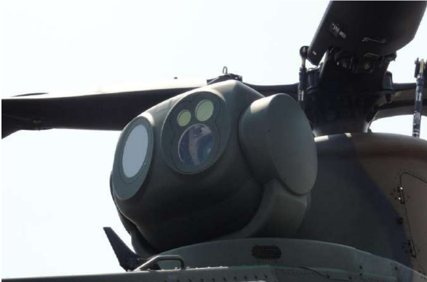
المستشعر الكهربوي الموجد على الجزء العلوي من جسم الطائرة OH - 1
