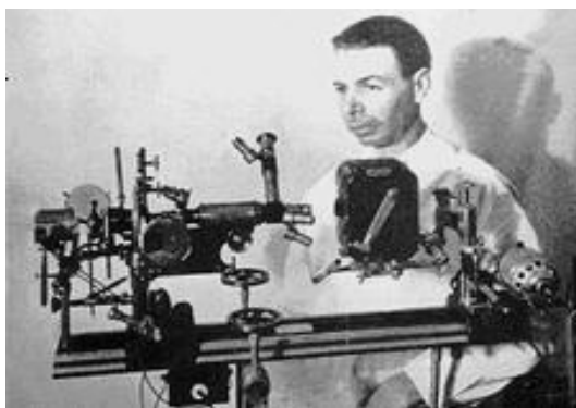
رايف يثبت آلة تصوير سينمائية على مجهره ليسجل ما رآه على فيلم تسجيل.
