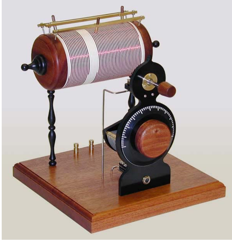
جهاز استقبال كريستالي. لا يحتاج لأي طاقة خارجية ليعمل
