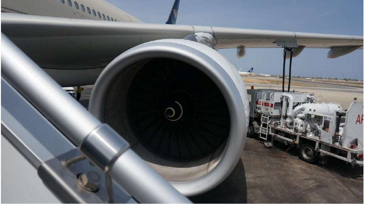
محرك رولز رويس ترينت 772 سي-60 مثبت على طائرة الخطوط السعودية إيرباص إيه 330-300
