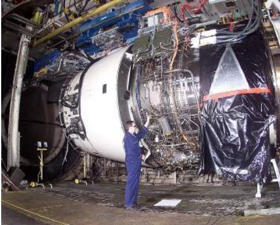
رولز رويس ترنت 900 في اختبار
