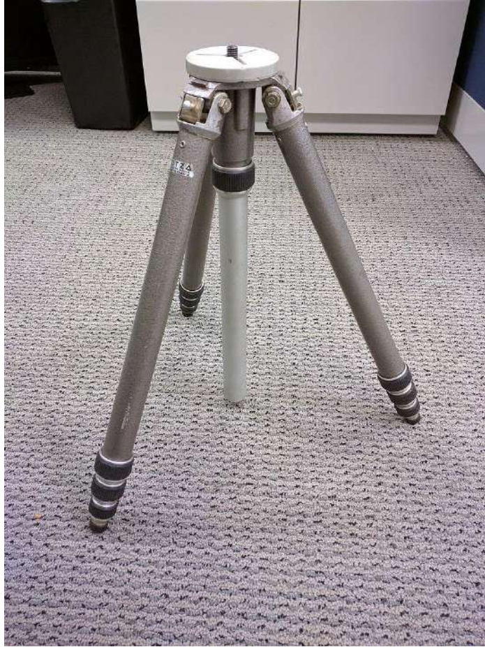
حامل ثلاثي القوائم مع فتحة أرجل "قياسية" بزاوية 24 درجة، بدون ملحقات.
