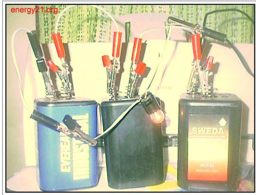
صورة تبيّن طريقة توصيل البطاريات
