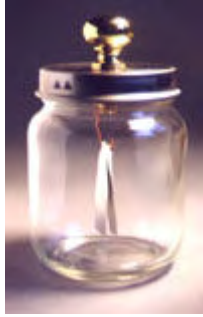
المقياس الكهربائي الشائع خلال بدايات استكشاف الكهرباء عبارة عن مرطبان زجاجي وفي داخله ورقتين معدنيتين
