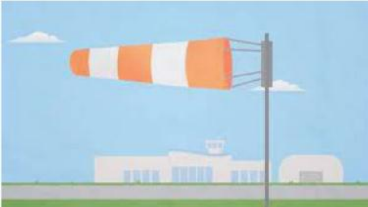
صورة لأداة كم الرياح و تستخدم لتحديد اتجاه الرياح
