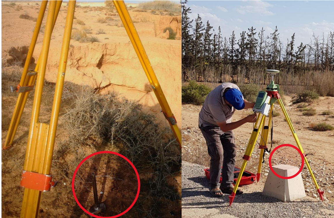
الصورة رقم 42: تثبت الجهاز على نقطة مرجعية موجودة بالميدان، أو تم إنشائها
