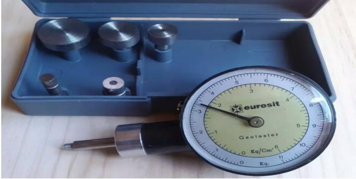
الصورة رقم 29: قياس تماسك التربة Pénétrömètre 1kg/1cm 2 type
