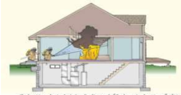
مكافحة حرائق المباني بطريقة غير مباشرة بطبخ المياه الى مكان السقف المحترق وبالتالي تبريد الأبخرة والغازات وارتداد المياه الى مصدر الحريق
