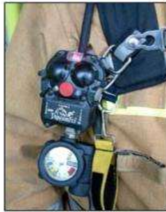
جهاز إنذار مدمج مع جهاز التنفس
