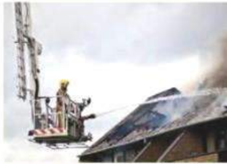
Elevated master stream devices can be mounted on aerial apparatus مكافحة حرائق المباني عن طريق عريّة السلم الدوار
