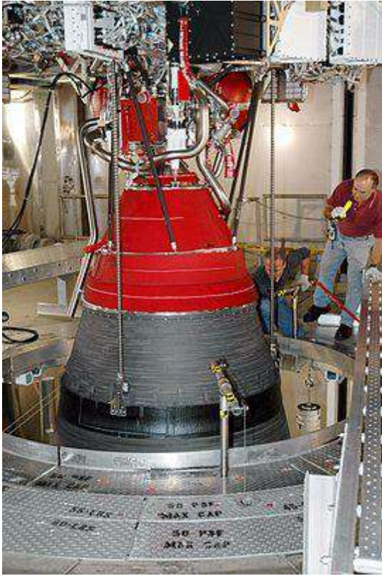
منفذ المحرك الصاروخي RL-10B-2 خلال الاختبار، قارن بالصورة
